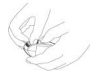
Для удаления батарей из блока мотопривода откройте крышку батарейного отсека и надавите на батарею с края, ближайшего к средней оси блока. Теперь батарею можно извлечь, выдвинув ее из отсека. Для извлечения остальных батарей из блока покачайте их. Закройте крышку батарейного отсека.
