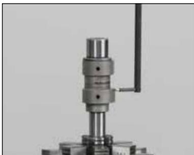
使用径向直线度单元(RSU)可以实现跟随测量模式，这种模式可以跟踪零件的表面，测量锥体、花键、凸轮轴、等速万向节等。
