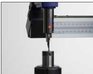
泰勒·霍普森拥有专利权的传感器方位角/转向技术结合了“任意方位”Talymin 6 传感器\*，可轻松测量各种结构复杂的零件。
