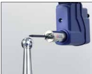
一个简单的自动化程序，允许用户在不需要手动输入的情况下设置所有轴的坐标位置，避免了操作员错误，确保了编程时的位置一致性。
