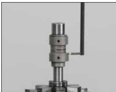
使用径向直线度单元(RSU)可以实现跟随测量模式，这种模式可以跟踪零件的表面，测量锥体、花键、凸轮轴、等速万向节等。
