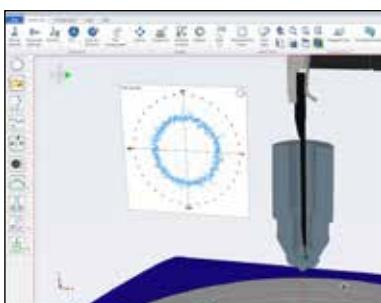
一个强大的工具，能够围绕 CAD 模型进行在线和离线编程。其特点包括测针针尖“移动路径”设定，并支持碰撞检测。
