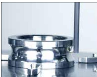
这款世界领先的传感器的量程为 4 mm，是大多数圆度仪量程的两倍。这使得用一个传感器就可测量圆度、轮廓和粗糙度。
