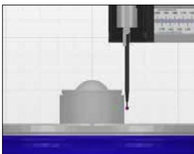
一种简单的测量仪校准方法，只需几秒钟就可以完成。该程序利用仪器的高精度刻度，使用户可以在一次操作中同时校准测量仪增益和测针摆角位置。
