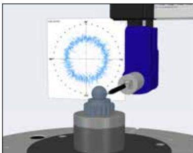
可选的真空夹具能够固定极小且易碎的零件，无需直接夹紧。真空夹具不会影响圆度测量、噪音或其它检测过程。能够轻松测量精密零件如滚珠轴承等。真空夹具方便拆卸，可测量较大的或不需要真空夹具的零件。
