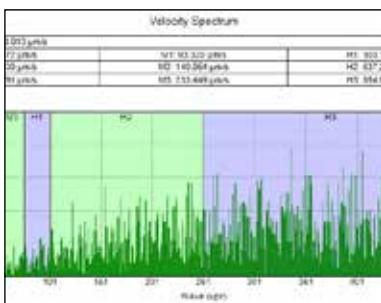
速度分析是一个经过测试的用于评估低噪音、高精度轴承和其他精密旋转表面的功能。
